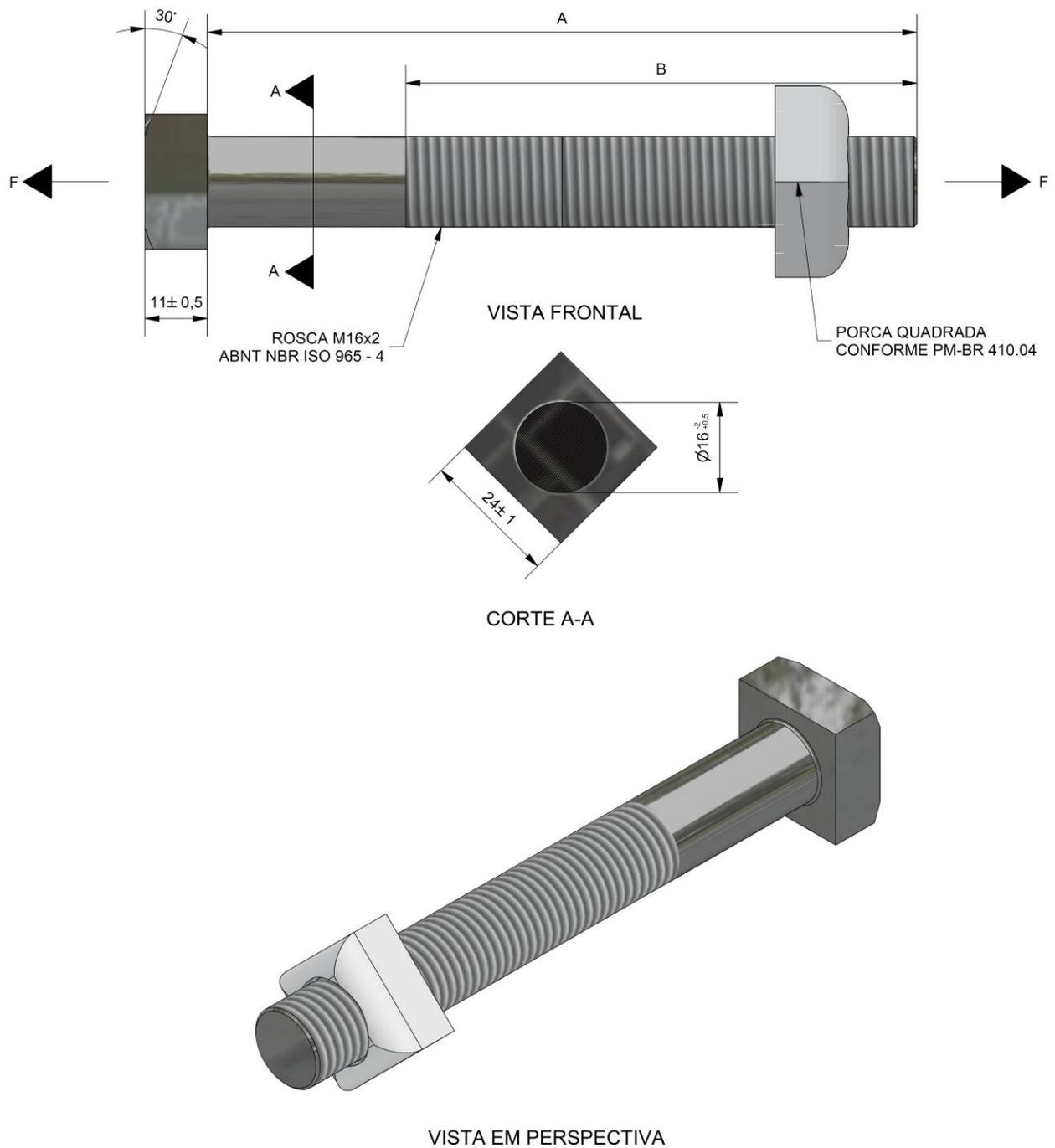
**Figura 1** - Parafuso Cabeça quadrada - M16
